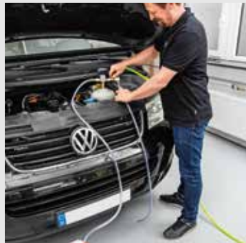
Den Ansaugschlauch einfach hängen lassen.
