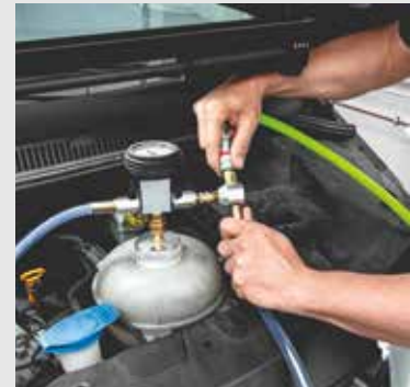
Dann den Druckluft- und Ansaugschlauch mit dem KVB verbinden.
