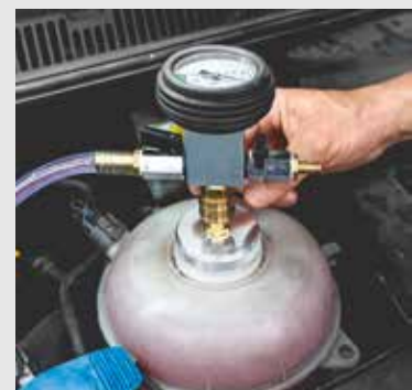
Zum Abschluss das Kühlsystem über den Ausgleichsbehälter befüllen.
