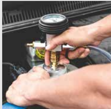
Nun das Kühler-Vakuum-Befüllgerät mit Schnellkupplung anschließen.
