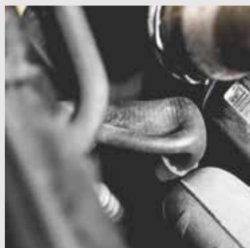
Das Vakuum zieht die Kühlerschläuche zusammen.
