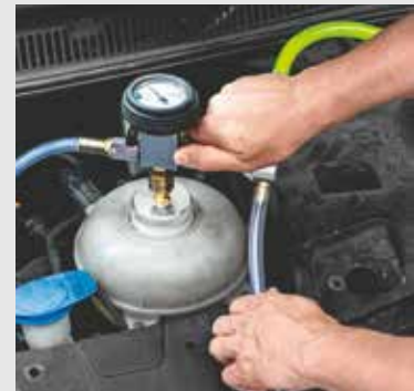
Nun das Ventil zur Venturidüse öffnen. Das Ventil zum Füllschlauch bleibt zu.
