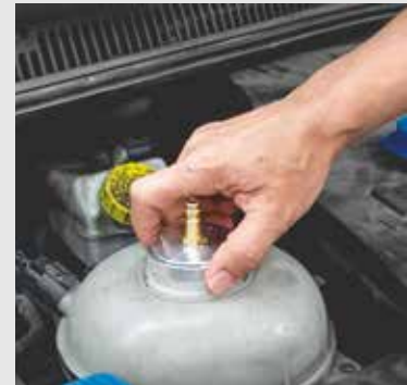
Den richtigen Adapter auf den Ausgleichsbehälter aufschrauben.
